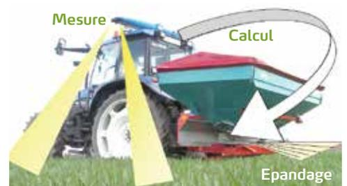
Figure 8- En temps réel, N-Sensor<sup>®</sup> mesure la réflectance du couvert végétal et évalue le niveau de nutrition azotée afin d'adapter la dose d'azote.
